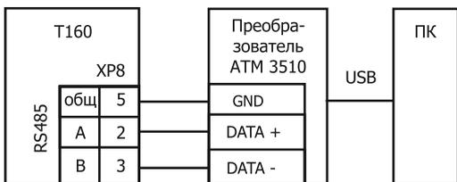
СХЕМА СОЕДИНЕНИЙ ПРИБОРОВ В ИНФОРМАЦИОННУЮ СЕТЬ
