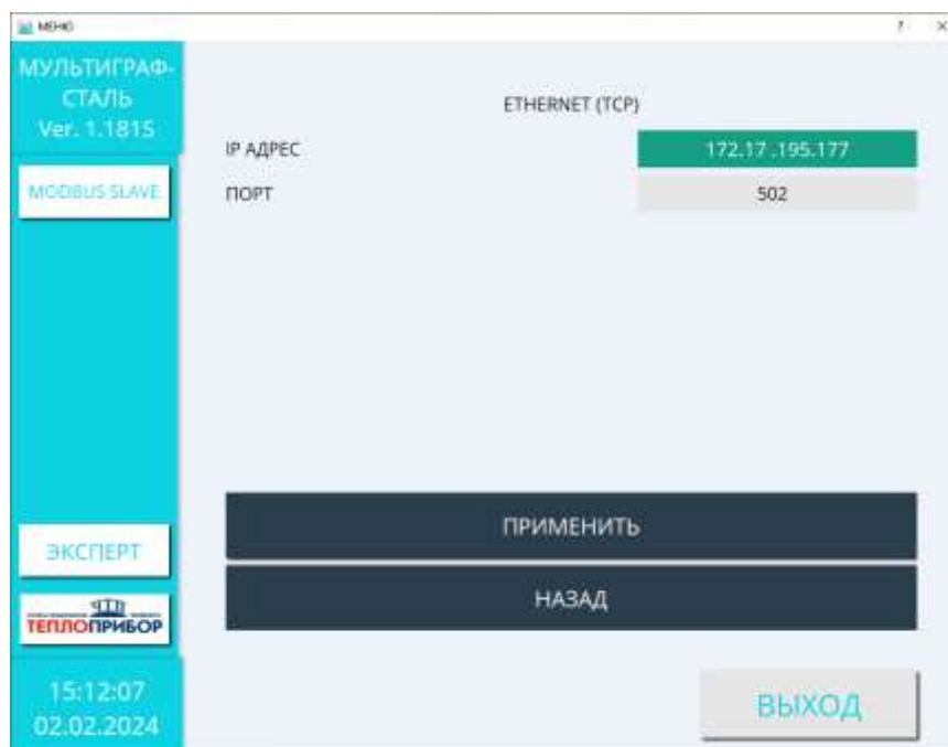
Рисунок 2.11 – Настройка связи по протоколу Modbus TCP slave (Ethernet)
