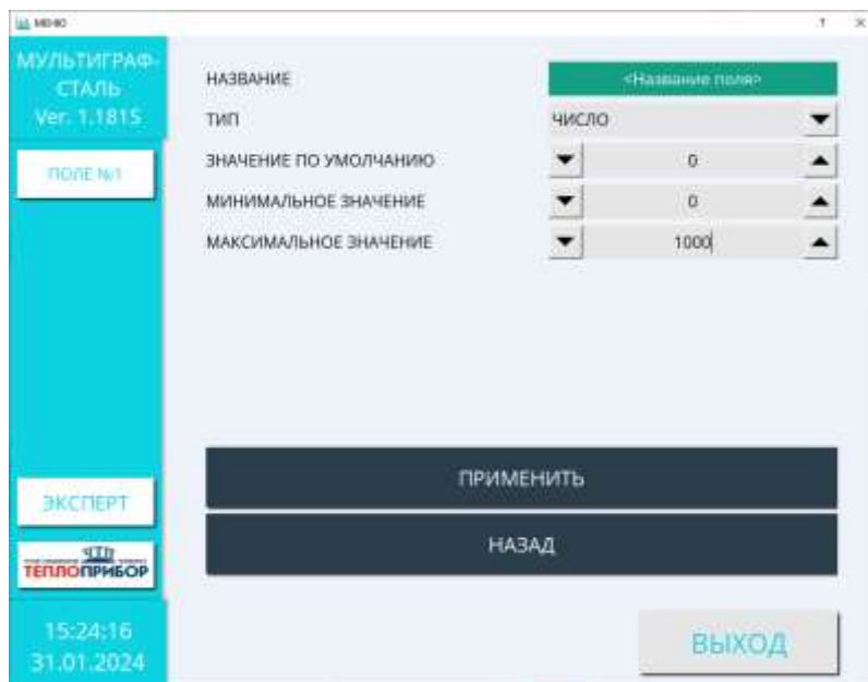
Рисунок 2.17 – Параметры настройки числового поля
