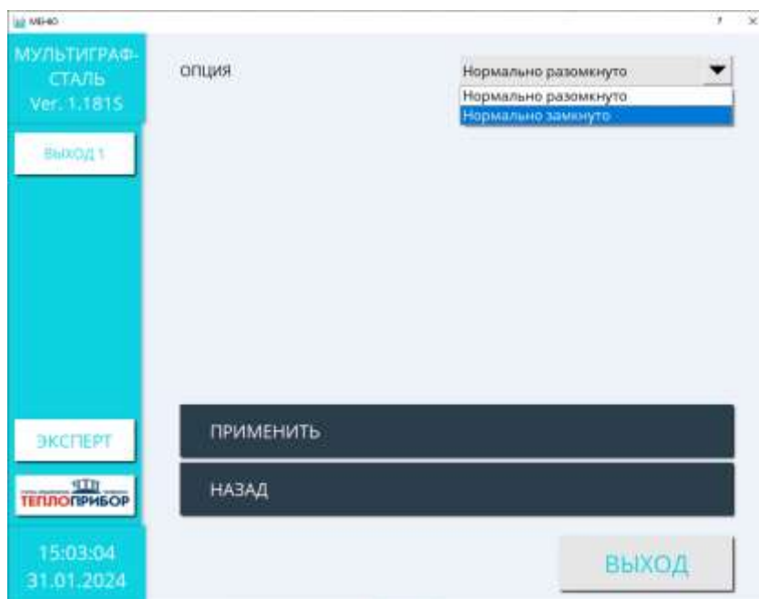
Рисунок 2.9 – Настройка канала дискретного выхода
